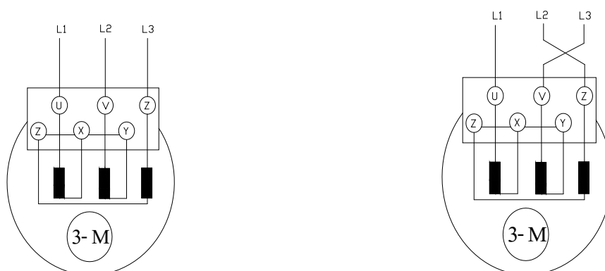
รูปที่ 10.12 ลักษณะการต่อวงจรเพื่อกลับทางหมุนมอเตอร์สามเฟส
